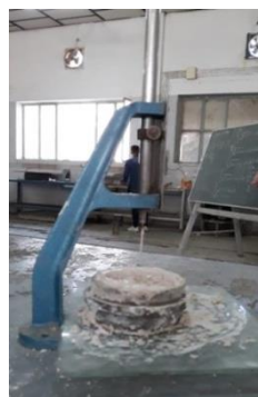
Fig.(1-b) : Vicat Apparatus
